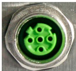
Abb. 28 Buchse für Ethernet
