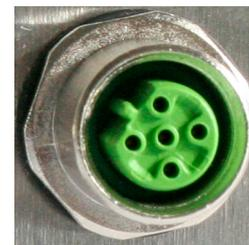
i Die Anschlussbelegung der 5-pol. M12-Buchse ist nicht genormt.
