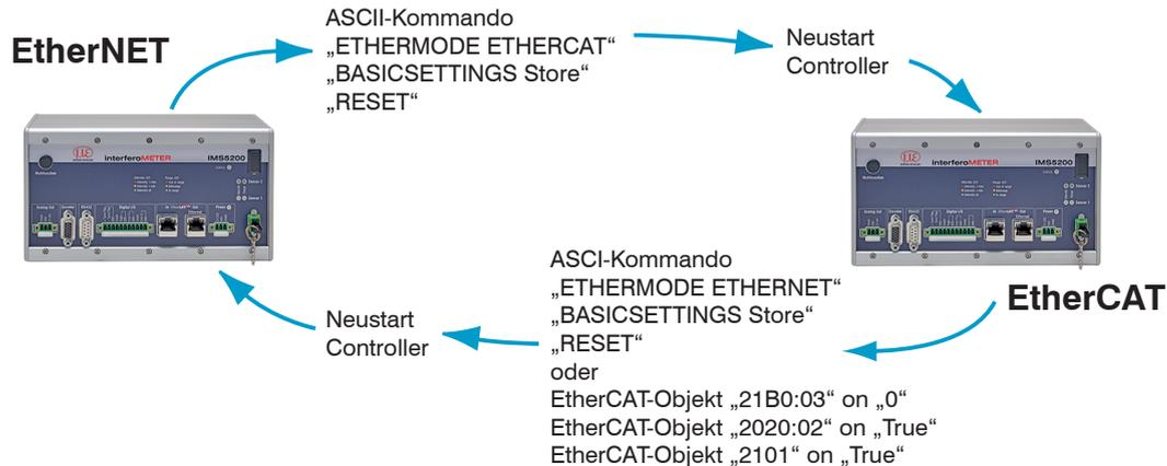
Die RS422-Schnittstelle für das Senden eines ASCII-Befehls ist sowohl im Ethernet-Mode als auch im EtherCAT-Mode verfügbar.
