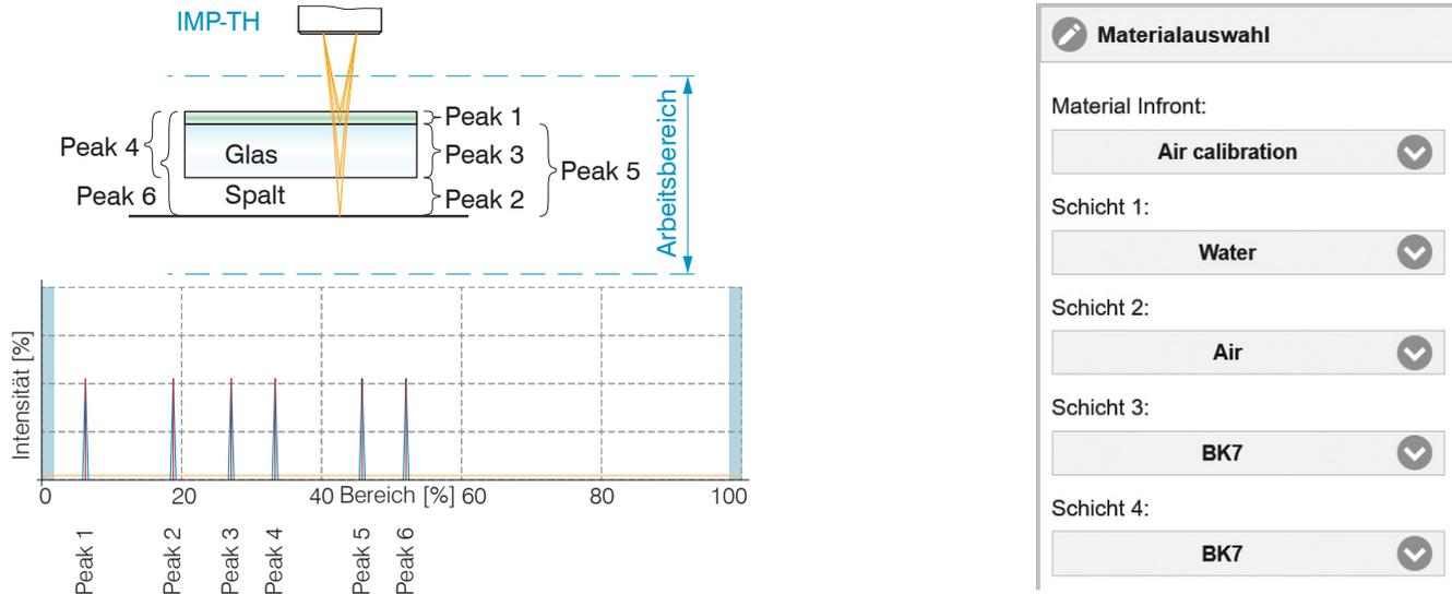
Der Controller IMS5200MP misst auch die Dicke der Kombinationsschichten des gesamten Materials.
