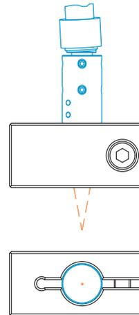
Diese Art der Sensormontage bietet die höchste Zuverlässigkeit, da der Sensor über sein zylindrisches Gehäuse flächig geklemmt wird.
