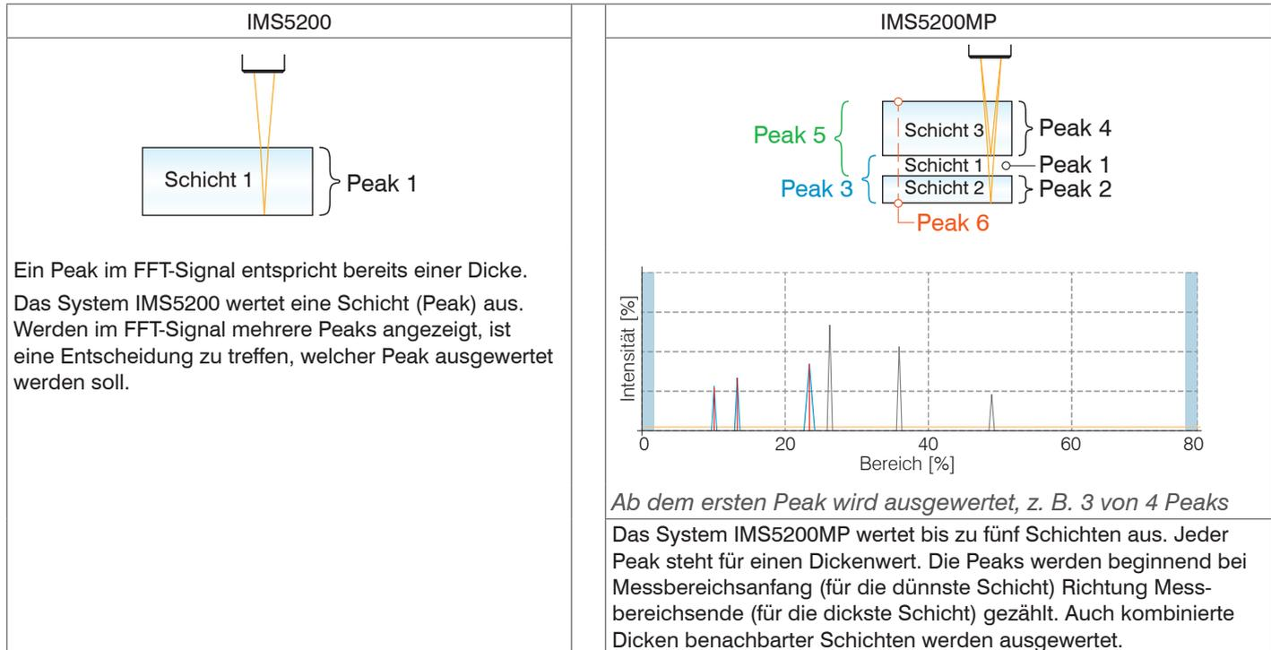
Bei einem Messobjekt, das aus mehreren transparenten Schichten besteht, ist eine Materialzuweisung pro Schicht erforderlich. Die Materialauswahl für eine Dickenmessung startet mit der dünnsten Schicht (Schicht 1) unabhängig von der physikalischen Anordnung im Messobjekt, siehe Kap. Materialauswahl.
