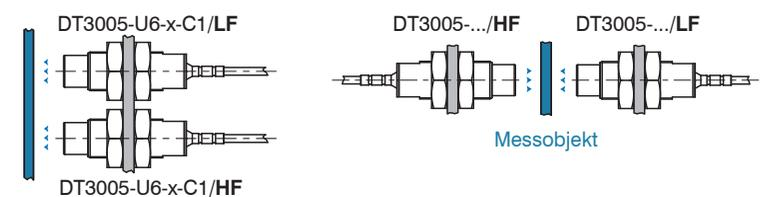
Beim Betrieb mehrerer eddyNCDT Messsysteme können diese mit einer neuartigen Frequenztrennung (LF/HF) geliefert werden. Die Frequenztrennung ermöglicht einen Mehrkanalbetrieb ohne gegenseitige Beeinflussung (Cross-Talk). Dank dieser Funktion ist eine Synchronisation über ein Synchronisationskabel nicht erforderlich.
