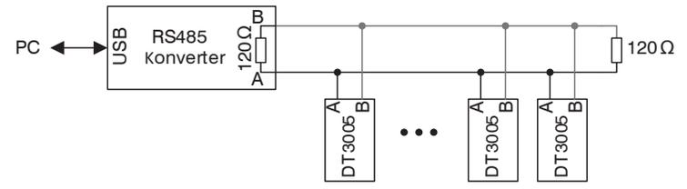
Anschluss des eddyNCDT 3005 an den PC mittels eines USB/RS485 Konverters
